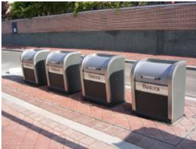
Εικόνα 58: Υπογείοι Κάδοι – η εξωτερική μονάδα
