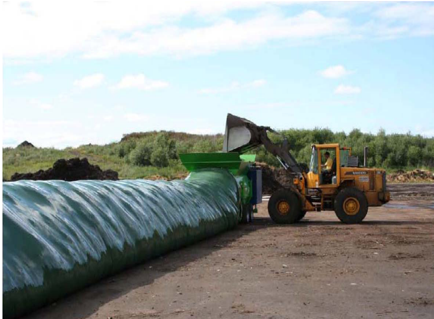
Εικόνα 31: Σύστημα κομποστοποίησης μέσα σε σάκους
